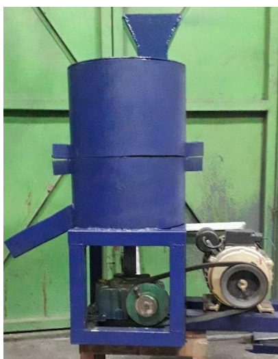
Gambar 3. Mesin Pencetak Biopellet
