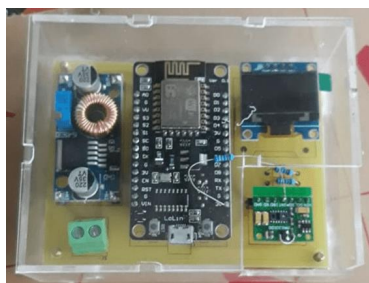
Gambar 3. Foto alat pengukur detak jantung berbasis IoT Blynk yang telah berhasil dibuat
